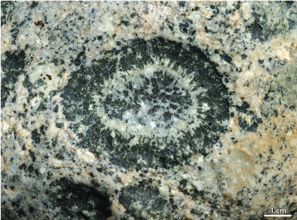
**Abb. 18.** Orbicul mit komplexem Aufbau: konzentrische Schalen mit radial ausgerichteten Mineralkörnern.
